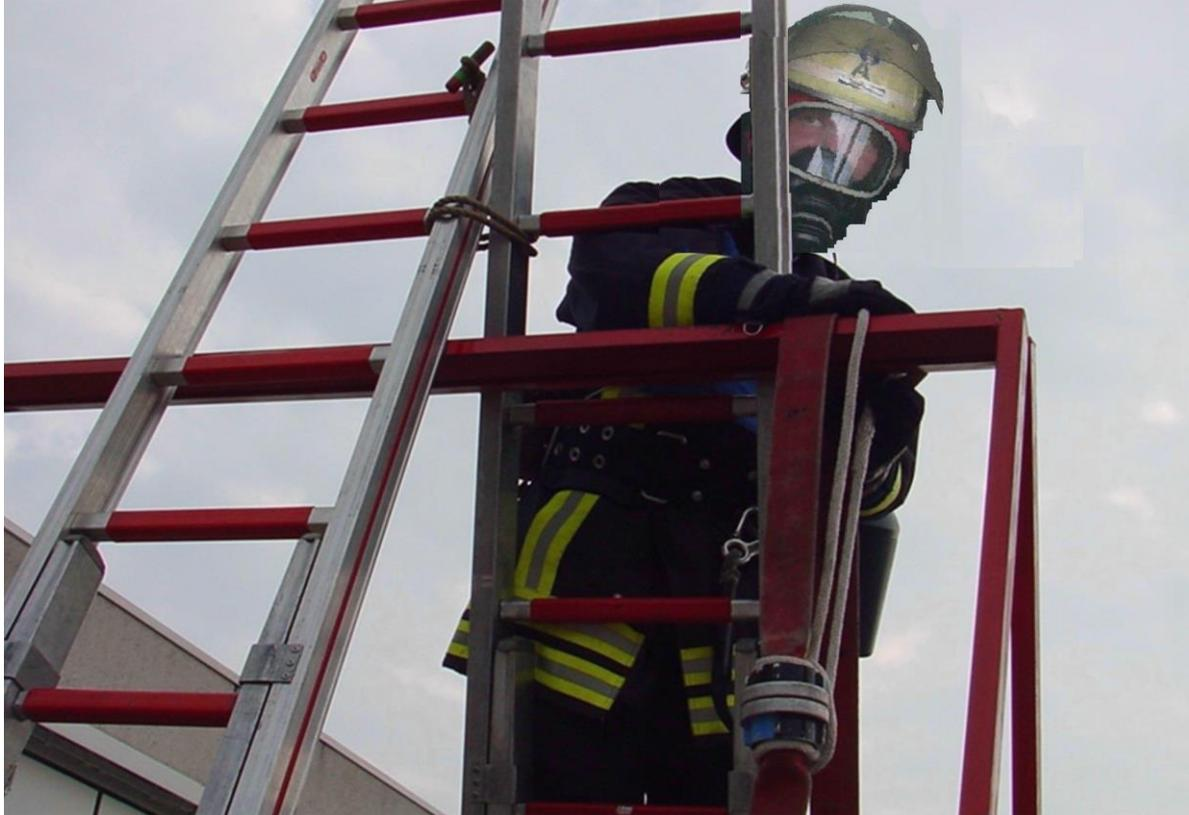
Sichern der Leiter und des Druckschlauches
